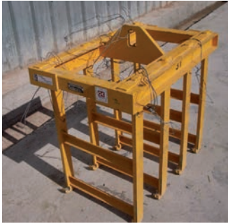
Schwellenumschlaggerät für 16 Schwellen (4x4), Bi-Block
