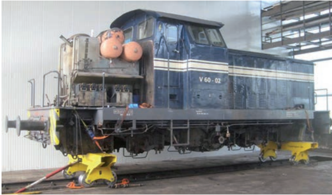
Ro-V 196c Rollbock zum Loktransport
